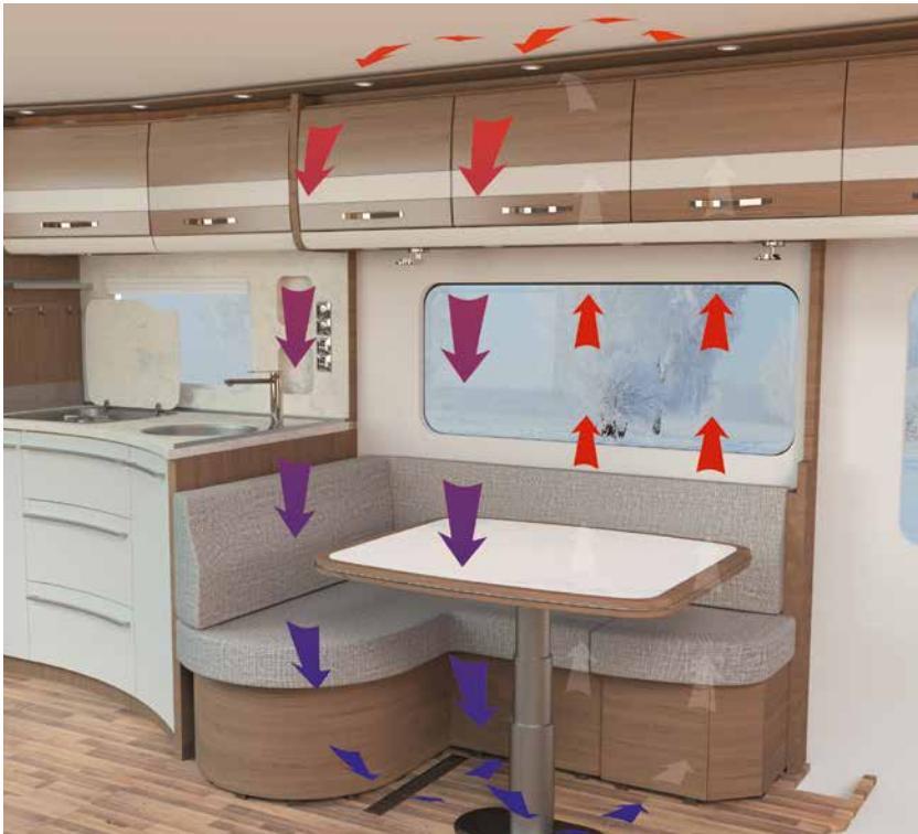
+ AirPlus-Systeem voor ventilatie achter de bovenkasten (zie pagina 57)
