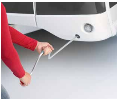
+ Invoerhulp voor eenvoudige bediening van de uitdraaisteunen
