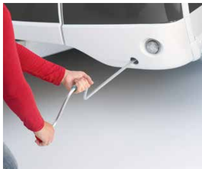
+ Invoerhulp voor eenvoudige bediening van de uitdraaisteunen
