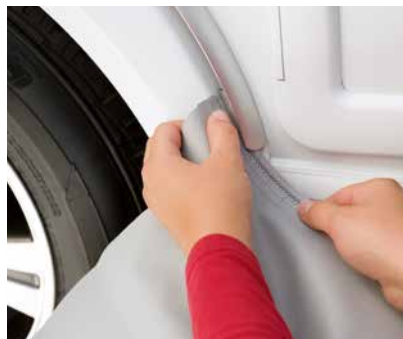
+ In het spatbord zit de rail voor de wieltrap fraai verwerkt
