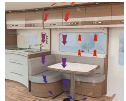
+ AirPlus systeem voor ventilatie achter de dakkasten (zie pagina 57)
