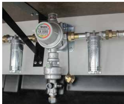
+ Duocontrol met crashsensor onderbreekt de gas toevoer in geval van een aanrijding
