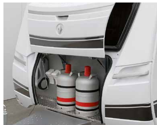
+ Geribbelde, aluminium bodem en een naar boven te openen disselbakklep
