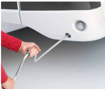
+ Invoerhulp voor een eenvoudige bediening van de uitdraaisteunen
