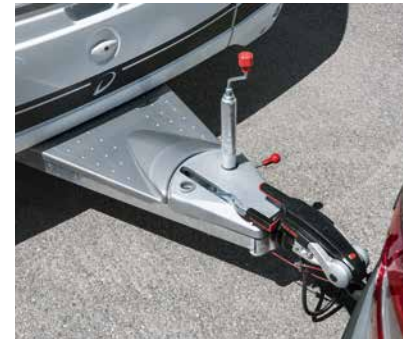
+ Stabilisator koppeling, die zijwaartse schok- en slingerbewegingen verhindert
