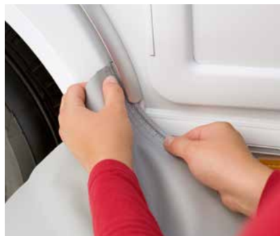
+ Rail voor wiel flap in de wielkast geïntegreerd
